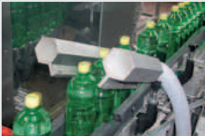
Вентилятор с насадками для сушки быстро и эффективно сушит бутылки.
