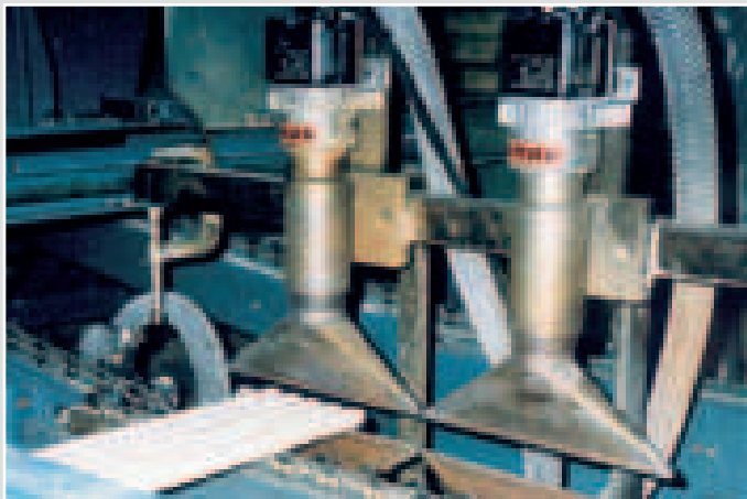
Нагреватели и вентилятор при нагреве концов ламп дневного света. При этом происходит удаление покрытия перед склеиванием.
