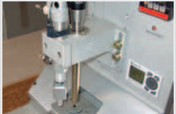
Воздуонагреватель LE MINI SENSOR нагревает пластмассовые заклепки, после чего идет расклейка холодным прессом.
