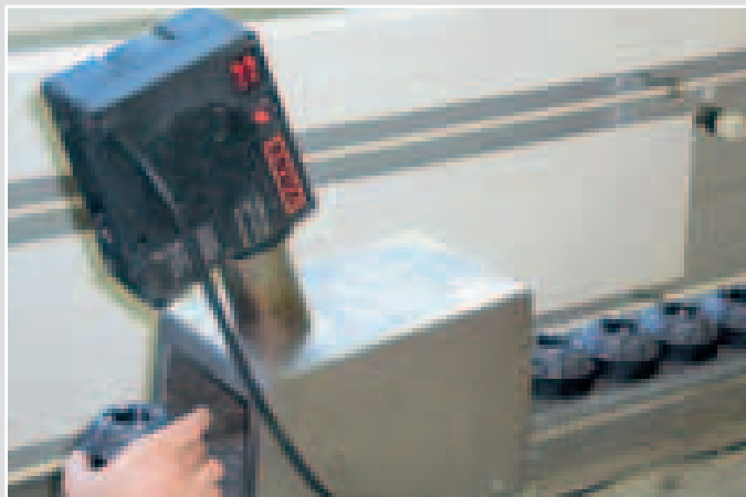
Тепловентилятор с рефлекторной тоннельной насадкой сушит краску после тампонной печати.
